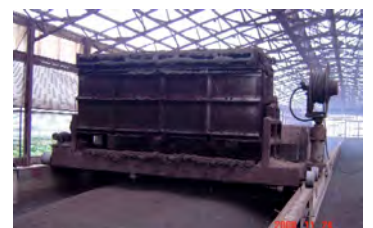
■攪拌機の上にある生ふん用のホッパーに資材も同時投入し、レーンに直接散布
